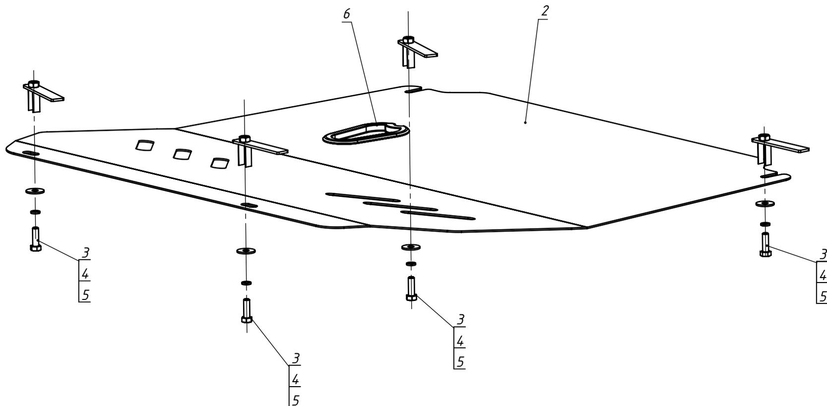
1. Установить закладные планки (поз. 1) в технологические отверстия в подрамнике радиатора и подрамнике двигателя.
